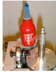
Sechskantschraube M6 mit Loctite 243 sichern, die Scheibe zwischen Gelenkkopf und Hauptwelle einsetzen.
