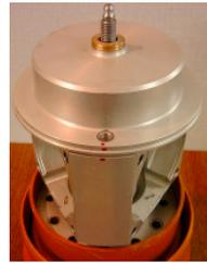
Alle Blätter sind bereits zueinander eingestellt, so dass sich bei nummerngleicher Montage der Lagerböcke, sowie durch richtige Positionierung des Kopfdeckels (siehe Markierung) die exakt gleiche Winkelstellung der Blätter ergibt. Sollte die Winkelstellung unter Umständen abweichen, so resultiert dies aus dem Spiel von 0,1 mm im Gelenkkopf zur Sechskantschraube.
