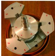
Blatt 2 und 3 mit Lagerbock zu den passenden Markierungen an der Nabe, nach oben sichtbar montieren.
